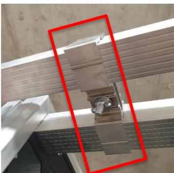
Es gibt 5 Verbindungselemente, damit mehrere Bühnenelemente miteinander verbunden werden können. Dadurch wird verhindert, dass Bühnenelemente verrutschen und eine Lücke zwischen den Elementen entsteht.
